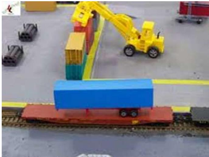
Figura 7.38 — Exemplo de aplicação de transporte multimodal piggyback.
