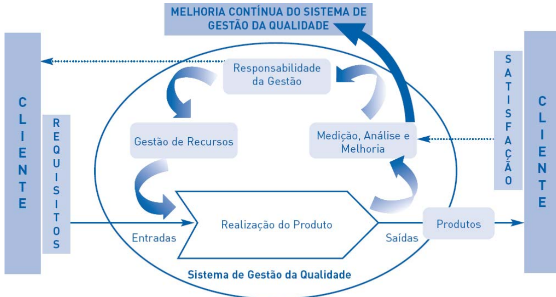
Figura 6 – modelo de um Sistema de Gestão da Qualidade baseado em processos (APCER 2003)
