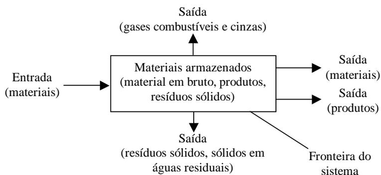
Figura 5.1 – Definição esquemática para a análise de balanço de materiais usada para determinar as taxas de geração de resíduos sólidos.
