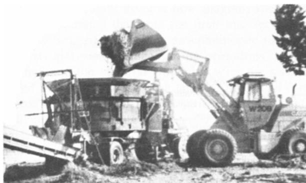
Figura 8.12 – Moinho de cuba usado para processamento de resíduos de pátios recolhidos separadamente.
