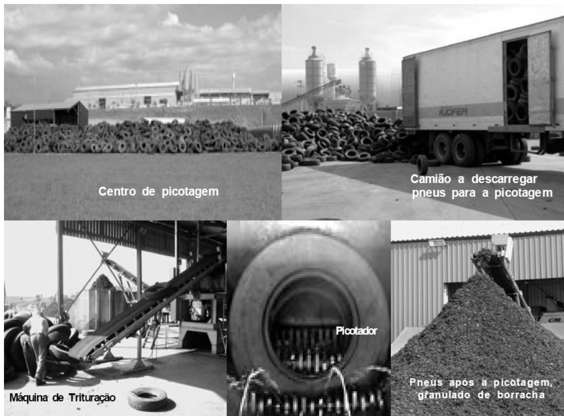
Fig. 2 – Processo de trituração dos pneus (LAGUNO, 2003)
