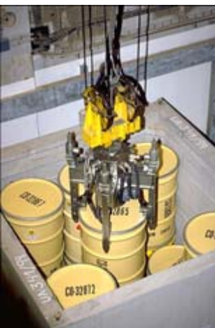
Transporte de residuos radiactivos acondicionados y contenedor de hormigón para transporte.
