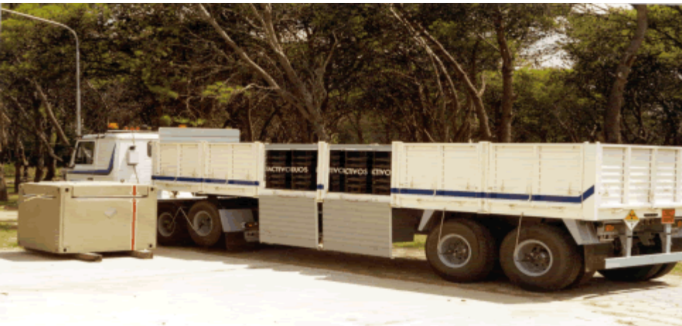
Transporte de residuos radiactivos acondicionados y contenedor de hormigón para transporte.
